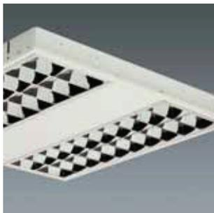
Hochglänzender Spiegelraster mit parabolisch geformten Längs- und Querreflektoren aus eloxiertem, nichttirsierenden Aluminium. Symmetrische Lichtstärkeverteilung mit Begrenzung der Leuchtdichte auf  $L < 200 \text{ cd/m}^2$  nach DIN 5035 und  $L < 500 \text{ cd/m}^2$  nach EN 12464.
