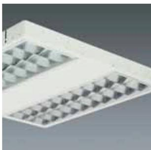
Mattglänzender Spiegelraster mit parabolisch geformten Längs- und Querreflektoren aus eloxiertem, nichttirsierenden Aluminium. Symmetrische Lichtstärkeverteilung mit Begrenzung der Leuchtdichte auf  $L < 200 \text{ cd/m}^2$  nach DIN 5035 und  $L < 500 \text{ cd/m}^2$  nach EN 12464.
