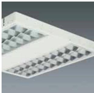
Aluminiumraster mit parabolisch geformten Längsreflektoren und flachen, profilierten Querlamellen aus satiniertem Aluminium. Symmetrische Lichtstärkeverteilung, geeignet zur Beleuchtung von Bereichen mit mittleren bis hohen Anforderungen für Sehaufgaben.
